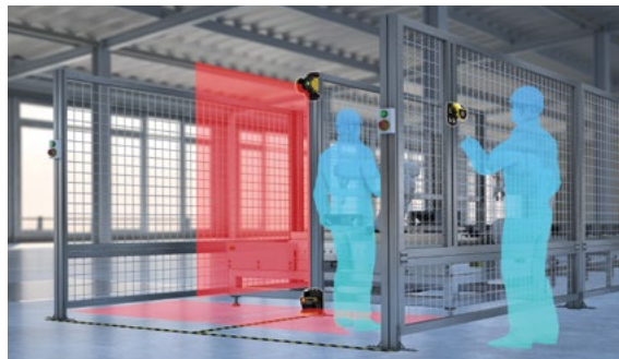
産業ロボットや自動走行車と人間がぶつかることを防ぐ セーフティレーザスキャナ
